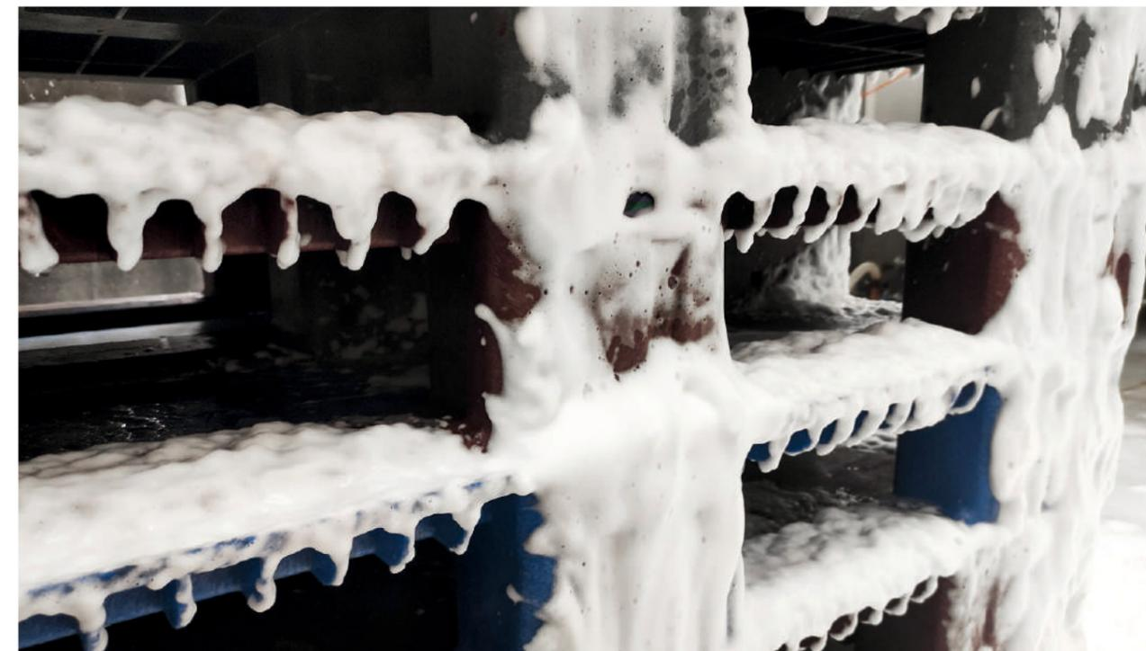
Система смешивания воды, воздуха и моющего средства спроектирована таким образом, что моющее средство засасывается из канистры с помощью образовавшегося небольшого избыточного давления. Это позволяет избежать дополнительных операций по смешиванию моющего раствора. После нанесения пены и выдержки соответствующего режима экспозиции (10-20 мин) пенный сателлит также легко переводится в режим «смыв» и струя воды удаляет моющий раствор с остатками белковых отложений и другими загрязнениями.
