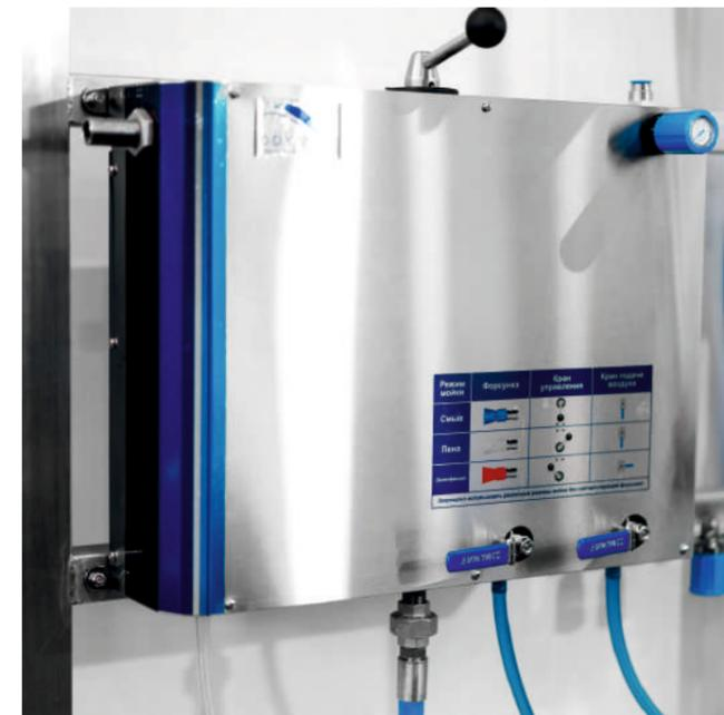
Стационарный пеногенератор SP3 имеет 4 режима работы: нанесение пены на основе щелочных и кислотных средств, дезинфекцию на основе НУК и смыв. Переключение режимов осуществляется на лицевой стороне пенного поста. Концентрация настраивается отдельно для каждого типа моющих средств и дезинфекции. Возможны различные варианты комплектации: с держателем шланга, барабанами, монтажными стендами.
