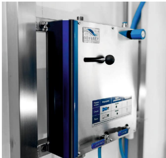
Стационарный пеногенератор SP2 имеет 3 режима работы: нанесение пены на основе щелочных и кислотных средств и смыв. Переключение режимов осуществляется на лицевой стороне пенного поста. Концентрация настраивается отдельно для каждого типа моющих средств. Возможны различные варианты комплектации: с держателем шланга, барабанами, монтажными стендами
