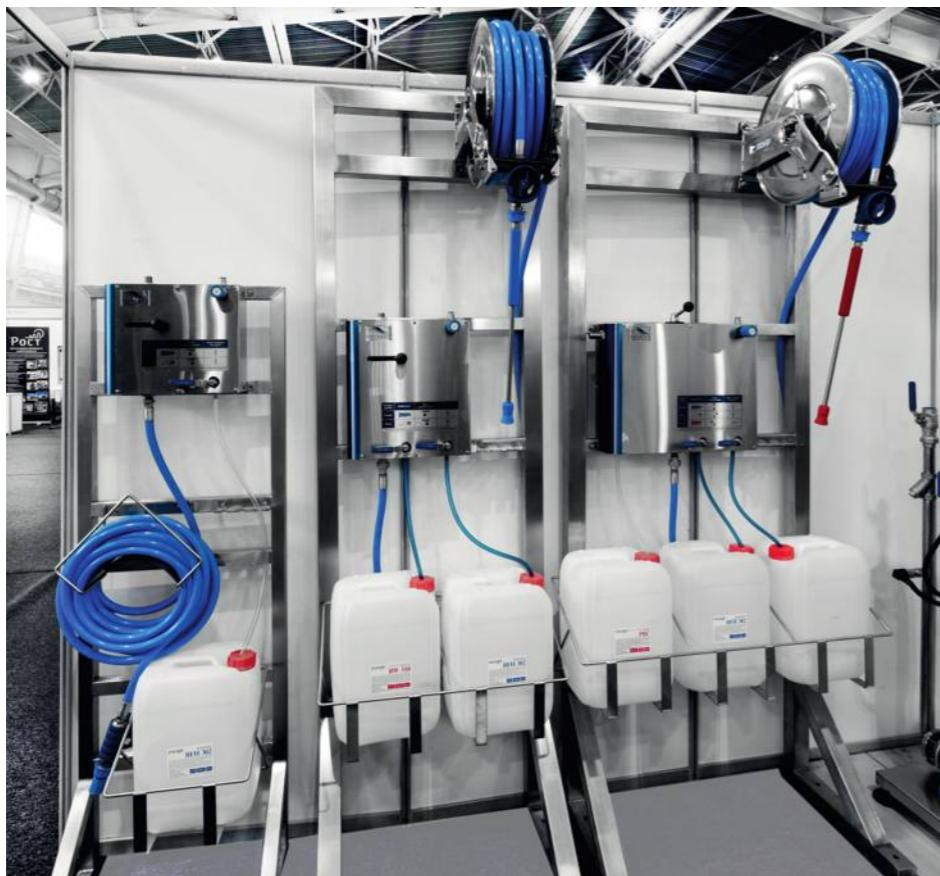
Стационарный пенный пост представляет собой установку, где происходит смешивание воды, моющего средства и сжатого воздуха. Основное назначение наносить пену и дезинфицирующий раствор на обрабатываемую поверхность.
